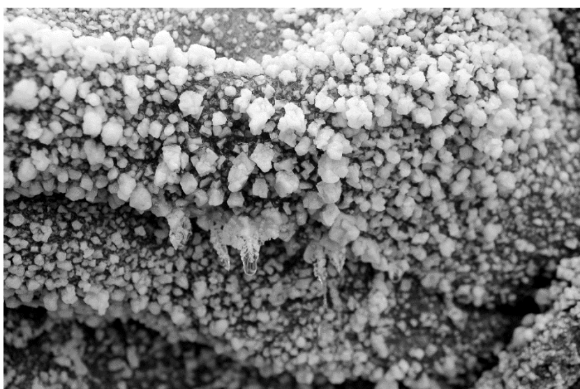
13. ábra: Makrokristályos sókiválás egy felszíni sófalon. Fig. 13: Macro-crystal salt deposit on the surface of a salt wall.
