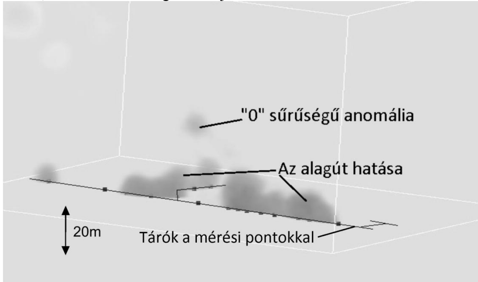
9. ábra: Az inverzió eredményének 3-dimenzióban. A sötétebb foltok jelzik az alacsony sűrűségű helyeket. Folytonos vonallal a tárók, pontokkal az egyes mérési helyek vannak ábrázolva. Világos vonalak az inverziós tartományt befoglaló téglatest élei.
