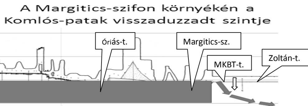
3. ábra: A sötétített terület a „Margitics-szifon” környékén a Komlós-patak visszaduzzadt szintjét mutatja, melyben az „MKBT-terem” és a „Margitics-szifon” víz alá került. A jobb oldali nyilak az elfolyás irányát mutatják a „Zoltán-terem” gyűjtő csövében keresztül a szabadba. Fig. 3. The shaded area around the "Margitics-trap" shows the level of Komlós stream, in which the "MKBT room" and under "Margitics-siphon" has been water. The right arrow shows the direction of the run-off through a "Zoltán room" manifold to the outside.
