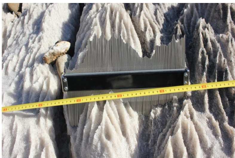
11. kép: Karrformák mérése profilfésűvel Picture 11: Measuring karst forms with profile comb
