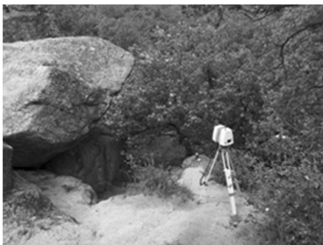
2. kép A Leica C10 lézerszkennő az Osztott-barlang délkeleti bejáratánál (Forrás: Nagy Gábor) Picture.2. The Leica C10 laser scanner on the southeast entrance of the Osztott-cave (Source: Gabor Nagy)
