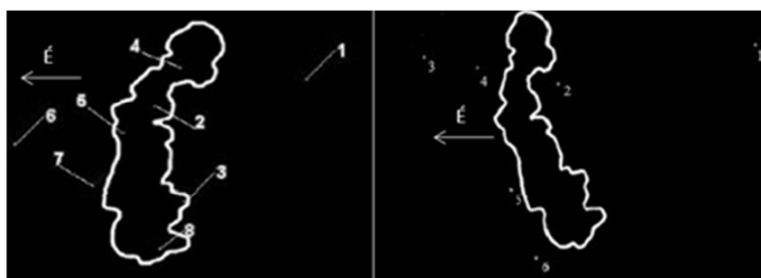
1. ábra Kapcsolópontok (bal oldal) és álláspontok (jobb oldal) a Pandúr-kőnél Fig.1. Target points (left side) and scan stations (right side) on the Pandur-stone
