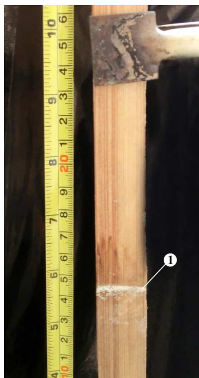
3. kép: Gyűrűs bevonat forma (1) a szuszpenziós edénybe merülő tárgyon Picture 3. Ring veneer (1) on the submerged object
