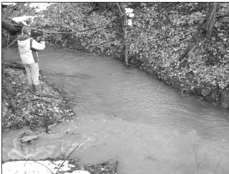
3. kép: Fluoreszcein észlelése a forrásban Picture 3: Visual observation of the appearance of fluorescent dyes in the spring
